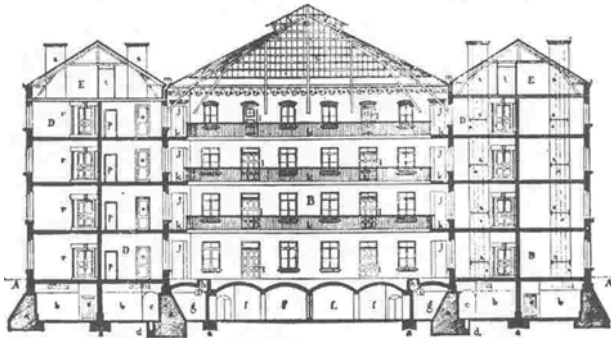
Σχηματική τομή του «Φαλανστέρ», σύμφωνα με όσα αναφέρονται στο «Traité...» 1. σοφίτα με δωμάτια για έξι άτομα 2. αποθήκες υψώσι 3. διακοσμητική...
