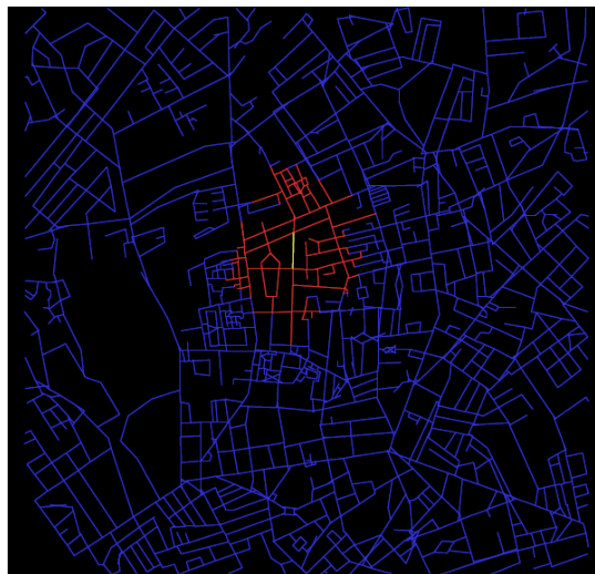
Εικόνα 3: Εφαρμογή Συντακτικής Ανάλυσης με ακτίνα 100 μέτρων. Περιοχή Εφαρμογής (κόκκινο) Πηγή: Getting Serious with Depthmap: Segment Analysis and Scripting (Turner, 2008)
