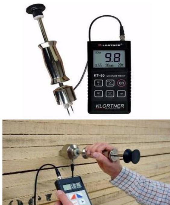
Εικόνα 8: Ηλεκτρικό υγρόμετρο και τοποθέτησή του πάνω σε στοιβαγμένη ξυλεία για μέτρηση της περιεχόμενης υγρασίας
