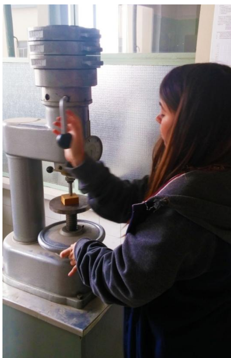
Εικόνα 9: Τοποθέτηση του εξεταζόμενου δοκιμίου στην τράπεζα δοκιμής και απελευθέρωση του φορτίου κατά την μέτρηση της σκληρότητας.
