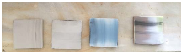
Εικόνα 9. Τα πλακίδια μετά το πείραμα αντοχής σε τριβή, πηγή: προσωπικό αρχείο.
