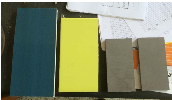
Εικόνα 17. Τα πλακίδια πριν από το πείραμα ελέγχου αντοχής σε κάμψη, πηγή: προσωπικό αρχείο.
