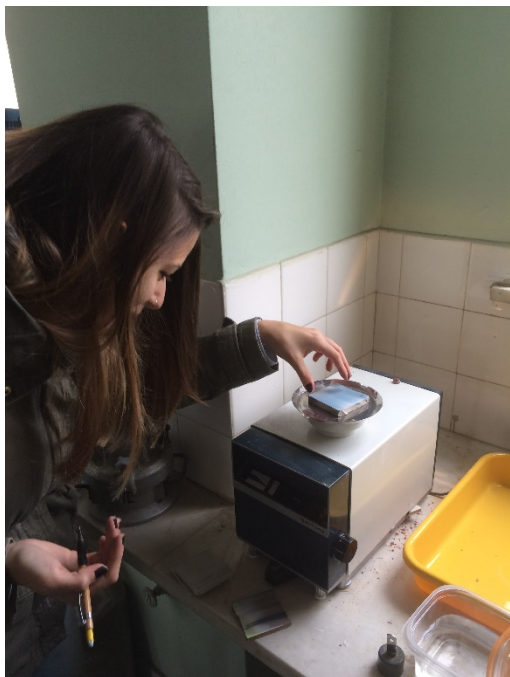
Εικόνα 6. Ζυγίζοντας το πλακίδιο λευκής πάστας μετά το πείραμα με την συσκευή ΒΟΗΜΕ όπου υπέστη φθορά λόγω τριβής, πηγή: προσωπικό αρχείο.
