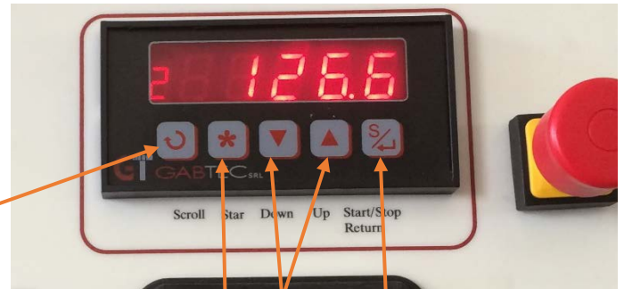
Εικόνα 11. Μικρή οθόνη με κουμπιά που αποτελεί χειριστήριο της συσκευής FLEXI, πηγή: προσωπικό αρχείο.
